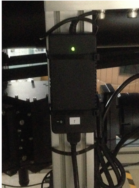
図4 CCDカメラのACアダプタ。アダプタの左下に電源ボタンがある。電源が入っている場合、アダプタ上部のLEDが緑に点灯する。
